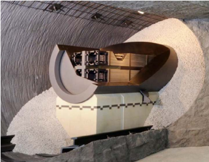
Abb. 1: Modell eines eingelagerten HAA-Behälters (Screenshot aus Nagra-Animation „Geologische Tiefenlager und ihre Oberflächenanlagen“)
